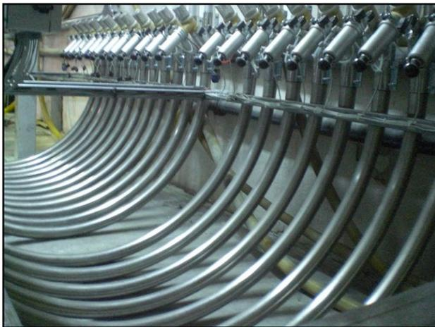
Wir entwickelten die computergestützte Beschickung (Computer Aided Feeding - CAF), um den Anlagenfahrern mehr Freiraum zu geben. Sie ist als ein halbautomatisches zentrales Beschickungssystem zu verstehen, mit dem erreicht wird, dass das richtige Material zum richtigen Extruder gefördert wird.
