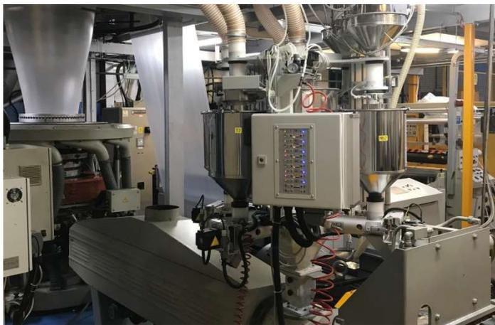
Die Wiege- und Dosierstation **GDS** ist für Mono- und Co-Extruder entwickelt, die mit Granulat bis 500 kg/h Durchsatz (**GDS**) oder mehr (**GDS/S**) arbeiten, und um das Messen und Regeln von bis zu vier bzw. sechs Dosier-, Additiv- oder Masterbatch-Komponenten zu integrieren. Alle Behälter aus Edelstahl mit besonders effektiver Materialzufuhr.
