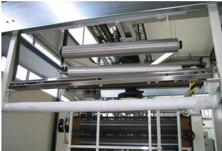
Über den Messrahmen wird eine flach aufliegende Folienbahn geführt. Auf beiden Seiten des Messrahmens bewegen sich Infrarotsensoren senkrecht zur Folienkante. Sobald die Folienkante erkannt wird, wird zyklisch die richtige Breite berechnet. Die Messung berührt nicht die Folienoberfläche.
