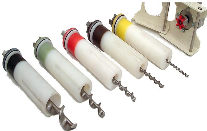
Der Schrittmotor des Dosierers ermöglicht eine genaue Dosierung in einem großen Durchsatzbereich (mit grüner Schnecke und Hülse von 0,5 bis 130 kg/h) ohne unnötigen Austausch der Dosierschnecken. Verschiedene Schnecken-/Hülsen-Sätze sind für unterschiedliche Anwendungen verfügbar, so dass die Dosierstation stets optimal genutzt werden kann.
